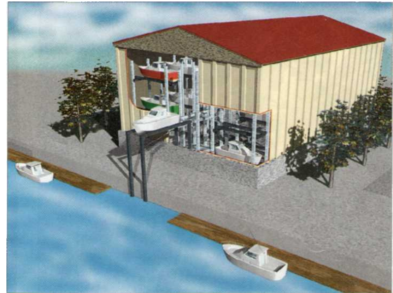
Le bateau est acheminé automatiquement sur rails de son box à sa zone de mise à l'eau. Le tout en seulement trois minutes.
